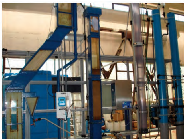
Figura 3. Complexul de Laboratoare Colentina - Stații pilot. Stânga: Stația pilot de tratare a apei, Dreapta: Instalație pilot de bioreactor cu membrane.
