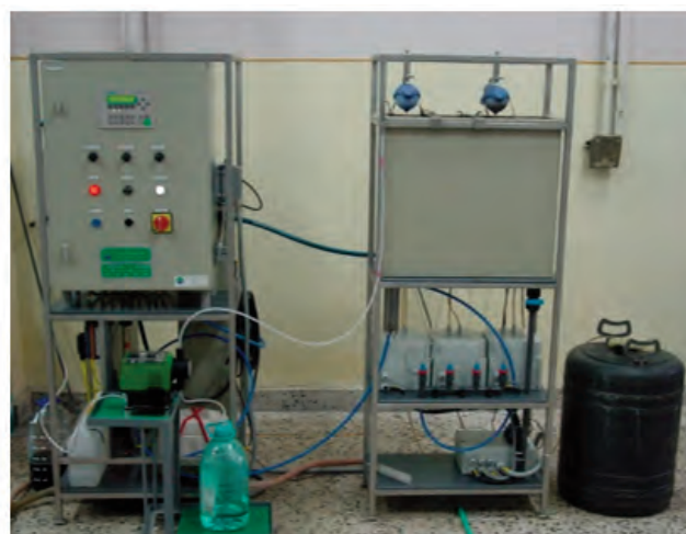
Figura 3. Complexul de Laboratoare Colentina - Stații pilot. Stânga: Stația pilot de tratare a apei, Dreapta: Instalație pilot de bioreactor cu membrane.
