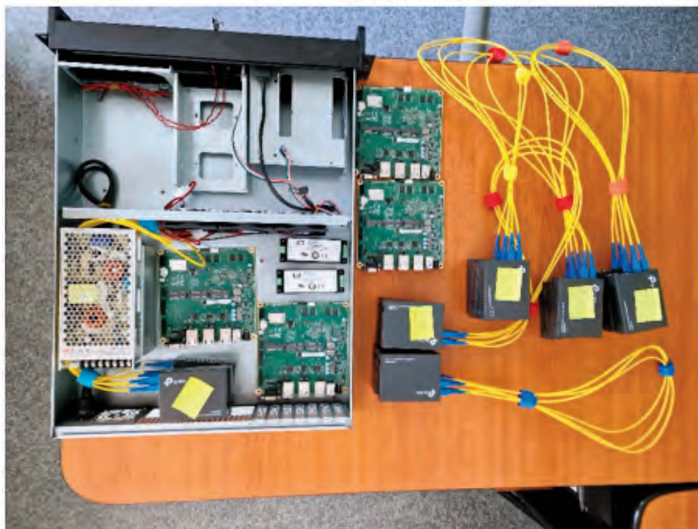
Fig. 5. Pompă de date în asamblare realizată cu diode de date și buclă de confirmare a recepționării transmisiunilor - dezvoltată în cadrul Universității Politehnica Timișoara
