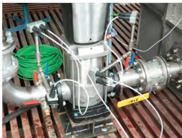
Fig. 5. Echipament de măsură bazat pe metoda termodinamică, [5]
