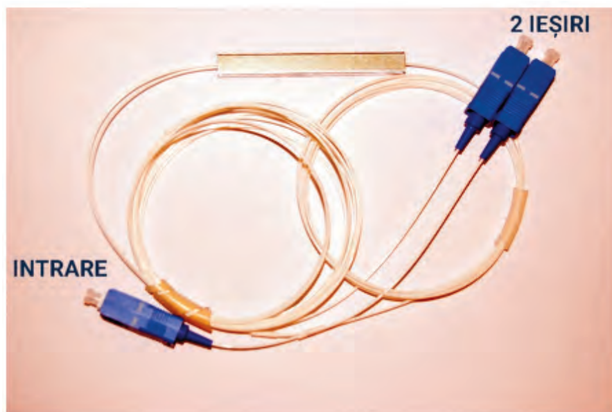
Fig. 2. Cablu de fibră optică cu o singură intrare și 2 ieșiri
